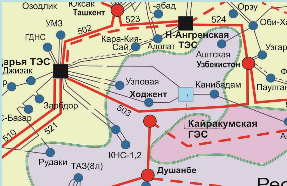
В зоне СДТЭС из шести линий в оперативной готовности только две, соединяющие СДТЭС с ПС Сугд (Л-20-С-1,2). Для подключения оставшихся четырех линий 220 кВ необходимо провести схемные изменения, связанные с перезаводкой линий.
